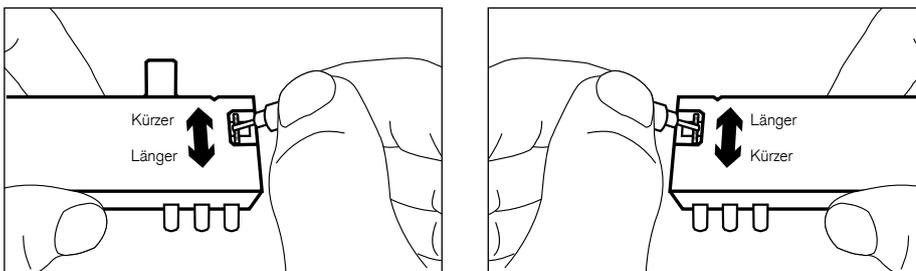
Usa il cacciavite in dotazione nel kit per ruotare la rotella nella direzione sopra mostrata ed effettuare la regolazione.
