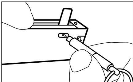
Fai questa regolazione con la dovuta cautela poiché la vitina cava potrebbe essere smarrita se svitata più del necessario. (In ogni caso un ricambio di questo pezzo è posizionato all'interno della parte superiore del Torque Adjustment Tool.)
