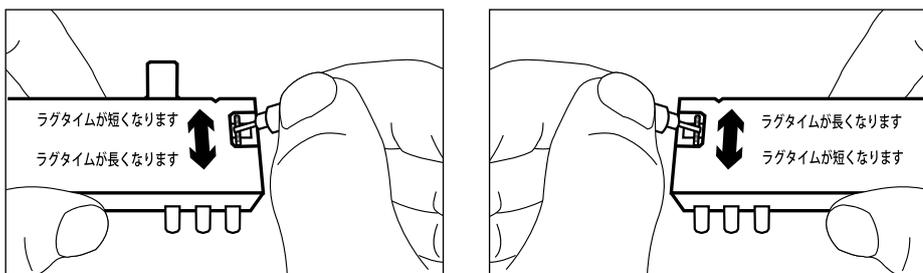
調整ツールのスクレュードライバーで図の様に調節ねじを回して、ラグタイムの調節を行って下さい。
